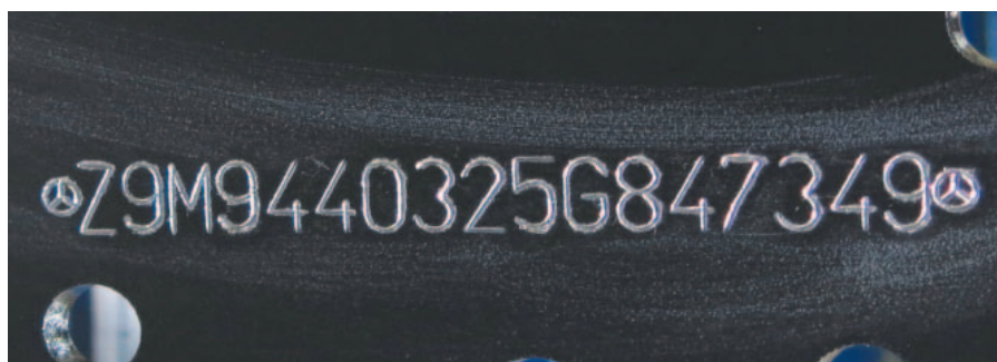
Рис. 9. Идентификационный номер сразу после нанесения.
