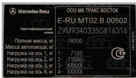
Рис. 12. Маркировочная табличка, выполненная при помощи лазера.
