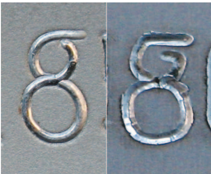
Рис. 5. Цифровое обозначение «8», выполненное в один этап
