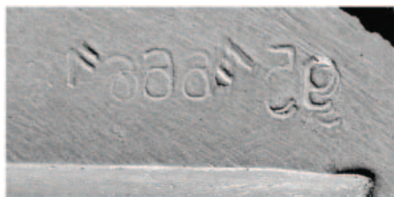
Рис. 3. Сканированное изображение слепка, выполненного с маркировочной площадки хвостовика колодки ружья ИЖ-43 (запекание пластики проведено при непосредственном контакте с объектом).
