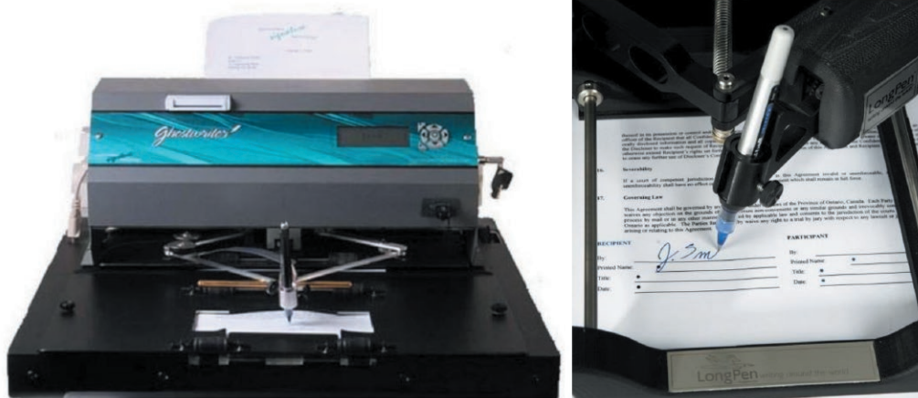
Рис. 2. Устройства с шарнирно-рычажным приводом: Ghostwriter MAX (слева), LongPen (справа) Fig. 2. Device with a ball lever drive: Ghostwriter MAX (left), LongPen (right)
