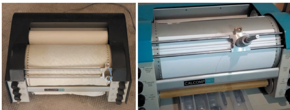
Рис. 3. Плоттеры Calcomp 565: с перфорированной рулонной бумагой (слева), с закрепленным листом без перфорации
