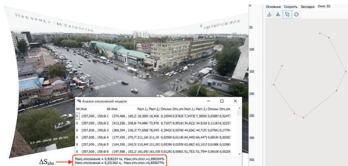
Рис. 9. Рабочее окно СПО «DTP-Expert» с результатами «Анализ отклонений модели»
