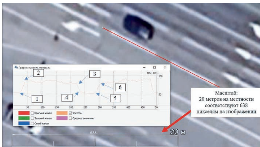
Рис. 6. Изображение ОФП из ГИС «Google Earth» с графиком яркости, построенным в «ДТП-Эксперт» вдоль линии красного цвета, наложенной на дорожную разметку. Красной стрелкой указана масштабная линейка
