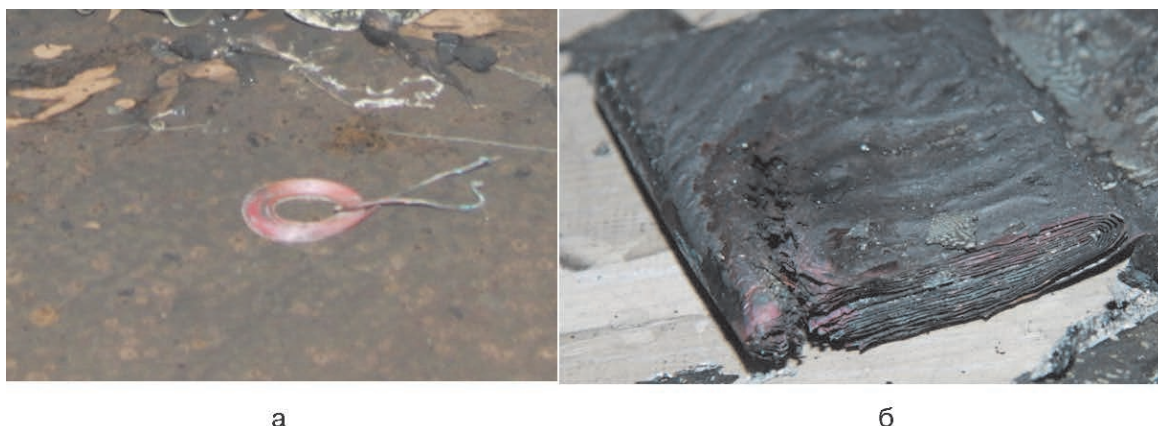
Рис. 10. Вид, предположительно, катушки индуктивности (а) внешнего аккумулятора (power bank) и поврежденного при пожаре литий-ионного аккумулятора (б)
