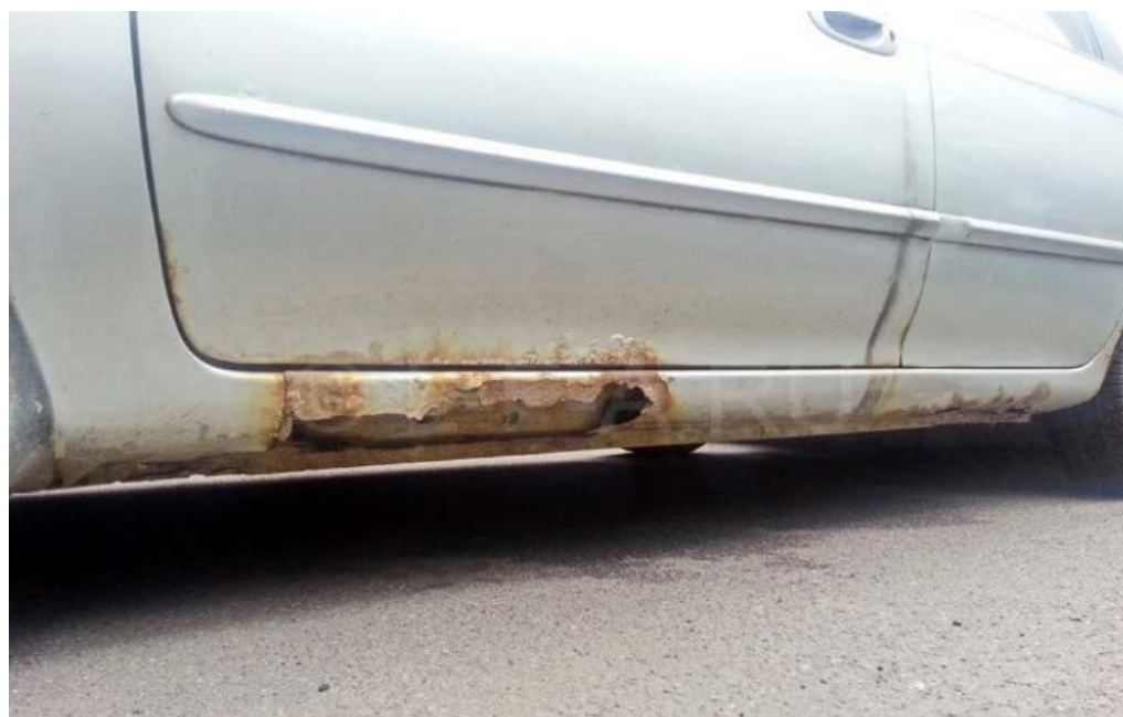
Фото 1, 2. Коррозия (в том числе сквозная) кузовных составных частей автомобилей Photo 1, 2. Corrosion (including perforation) of vehicle parts
