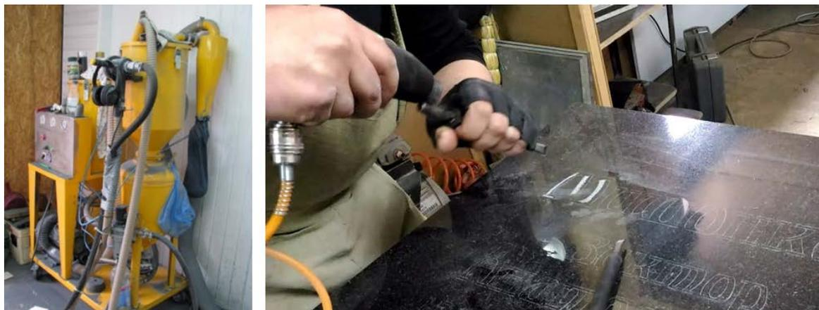
**Рис. 2.** Пример гравировки с использованием пескоструйной машины
