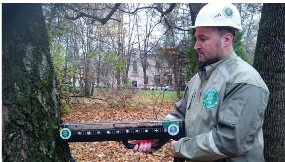
**Фото 3.** Обследование дерева прибором Resistograph®
