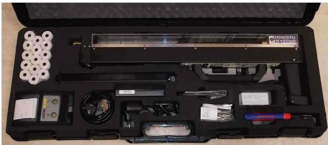
**Фото 2.** Внешний вид прибора Resistograph®
