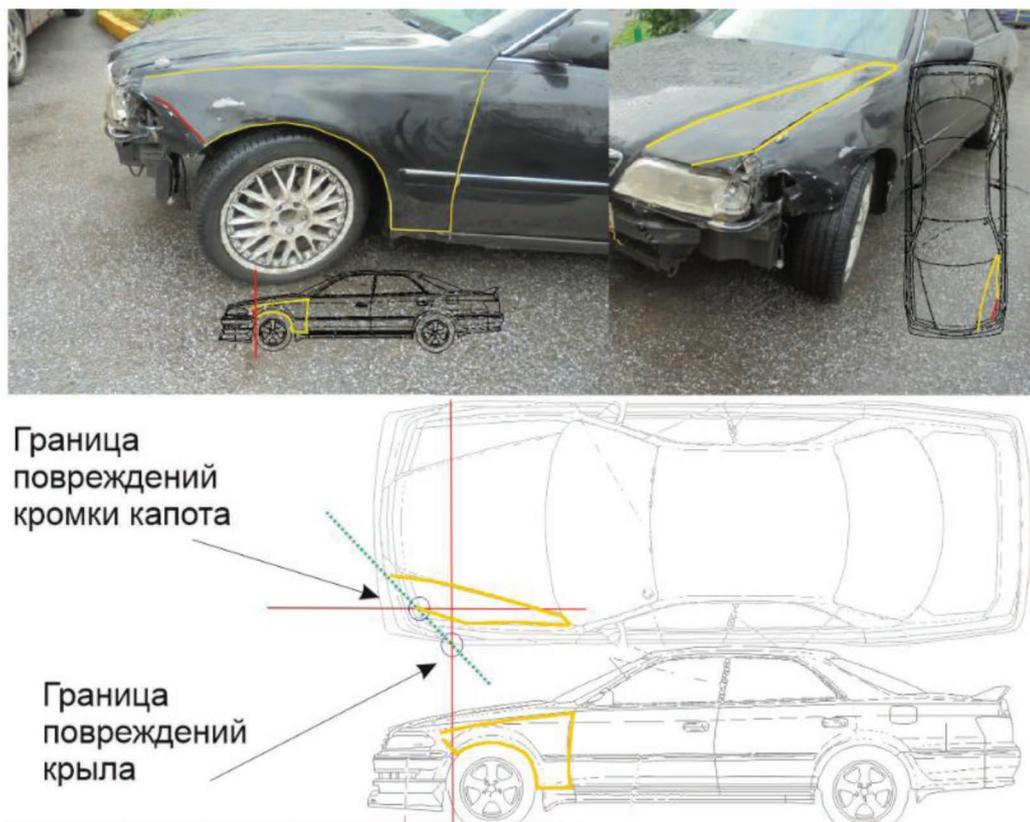
**Рис. 5.** Определение угла отклонения плоскости повреждения от продольной оси ТС:
