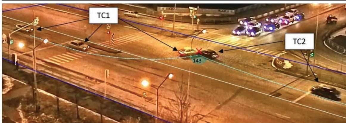
**Рис. 10.** Построение траекторий движения (линии голубого цвета) по положению переднего правого (TC1) и переднего левого (TC2) колес (DTP Expert 1.0)
