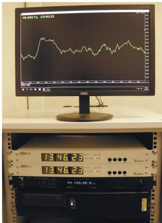
**Рис. 2.** Аппаратно-программный комплекс мониторинга значений частоты электросети
