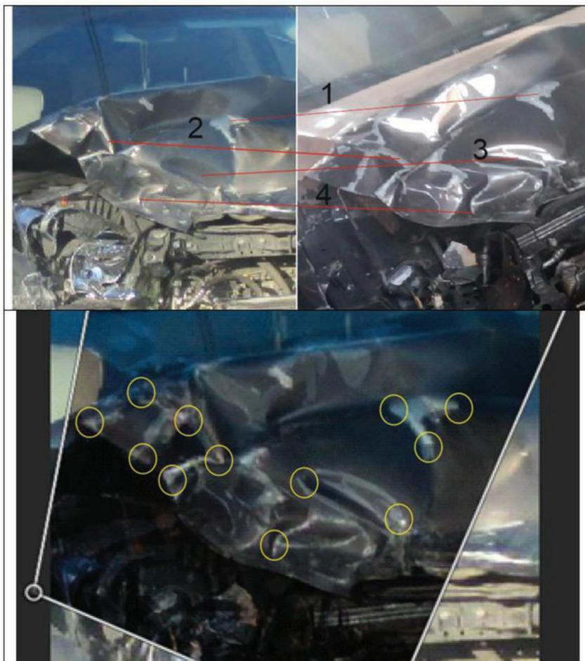
**Рис. 2.** Фотоизображение ТС после первого ДТП (слева) и после второго ДТП (справа), полученные в разном масштабе и с разных ракурсов. После фотокоррекции возможно применение метода совмещения и наложения (внизу). Желтым маркером выделена совпадающая совокупность признаков в виде излома металла и повреждений лакокрасочного покрытия
