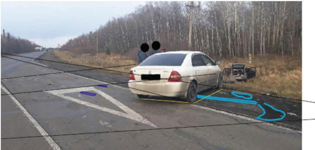
**Рис. 6.** Построение перспективы: черные линии – параллели и перпендикуляры к проезжей части, желтые линии – объекты с заранее известными геометрическими размерами, синие и голубые линии – границы следов, зафиксированных в ходе осмотра места происшествия
