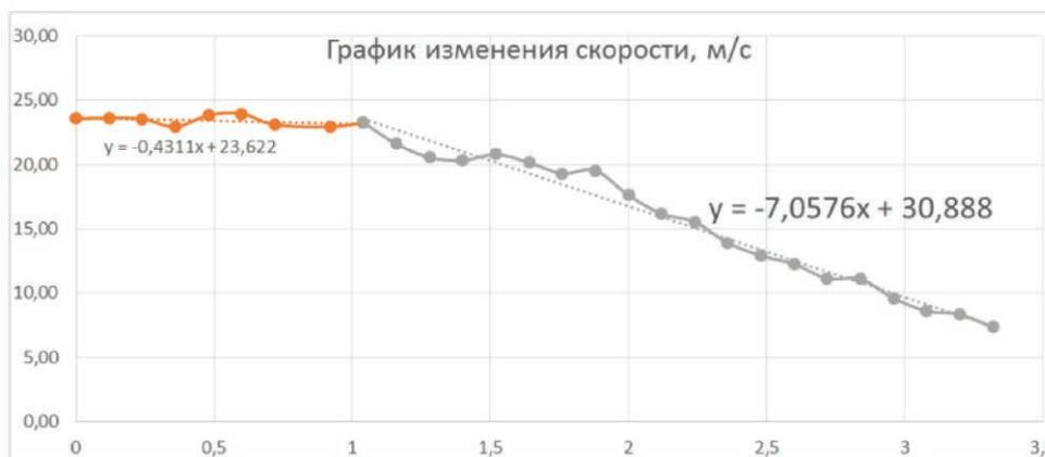
**Рис. 14.** Определение скорости движения и замедления автомобиля Mercedes Benz.
