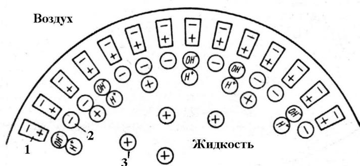
**Рис. 3.** Схематическое изображение ориентации диполей и ионов на поверхности воды [1, 4]: 1 –  $H_2O$ -диполь; 2 – отрицательный ион; 3 – положительный ион
