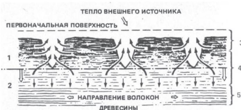
**Рис. 1.** Поперечный разрез бруса горящей древесины. 1 – зона растрескивания и образования трещин; 2 – ненарушенная зона; 3 – углистый остаток; 4 – зона пиролиза; 5 – зона, не охваченная пиролизом. Извилистыми стрелками указаны возможные направления движения летучих продуктов [5]
