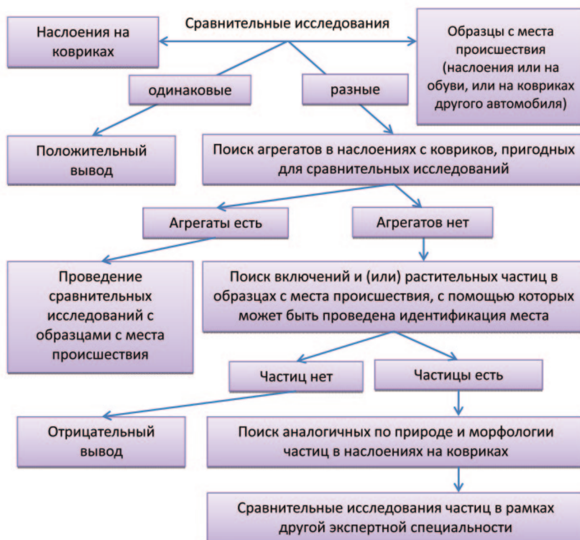
Рис. 2. Схема сравнительного исследования наслоений на ковриках автомобиля
