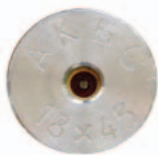
Фото 14. Маркировка гильзы патрона 18x45PШ производства ООО «АКБС».
