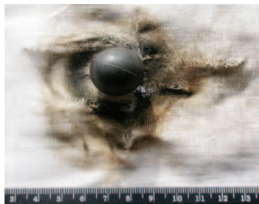
Фото 30. Общий вид повреждения на ткани, образованного выстрелом патроном 18х45РШ с дистанций 0см (упор). Для наглядности помещена пуля, которой образовано данное повреждение.
