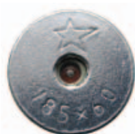
Фото 25. Маркировка на дне гильзы патрона 18,5x60Т.
