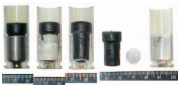
Фото 16. Последовательный продольный механический разрез гильзы патрона 18x45 производства ООО «А+А».
