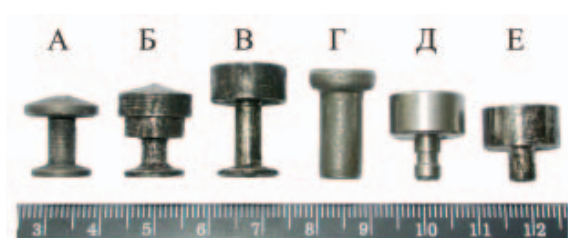
Фото 9. Общий вид стальных сердечников пуль травматических патронов комплекса «Оса»: А – первоначального варианта пули патрона 18х45Т производства ГУП ФНПЦ «НИИ прикладной химии», Б – модернизированного варианта пули патрона 18х45Т производства ГУП ФНПЦ «НИИ прикладной химии», В – пули патрона 18х45Т производства ООО «Новые оружейные технологии», Г – пули патрона 18х45Т производства ООО «А+А», Д – пули патрона 18,5х55 производства ООО «А+А», Е – один из вариантов пули патрона 18,5х60Т.
