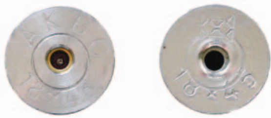
Фото 26. Следы контактного узла на дне стреляных гильз патронов разных производителей.
