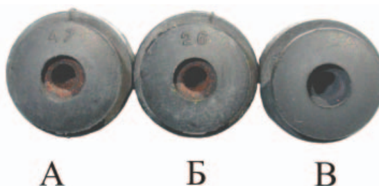
Фото 8. Пули патрона 18х45Т с маркировкой на донной части хвостовика (А, Б) и без нее (В).
