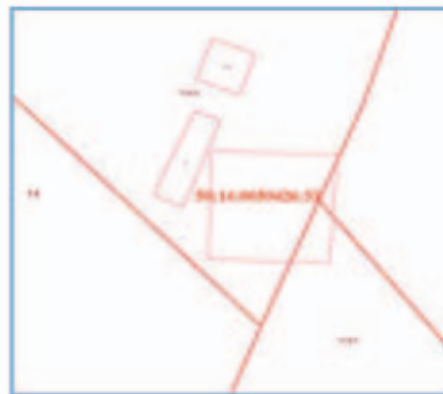
Рис. 2. Разворот границ вследствие ошибок в определении дирекционных углов
