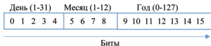
Рис. 2. Схема представления даты во временных штампах файловой системы FAT
