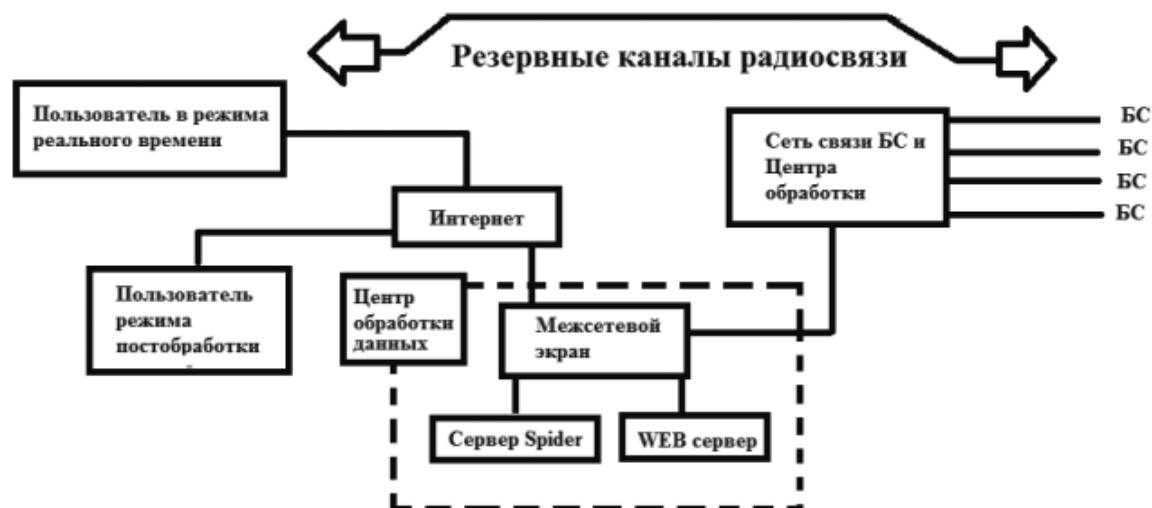
Рис. 11. Общий принцип работы базовых станций
