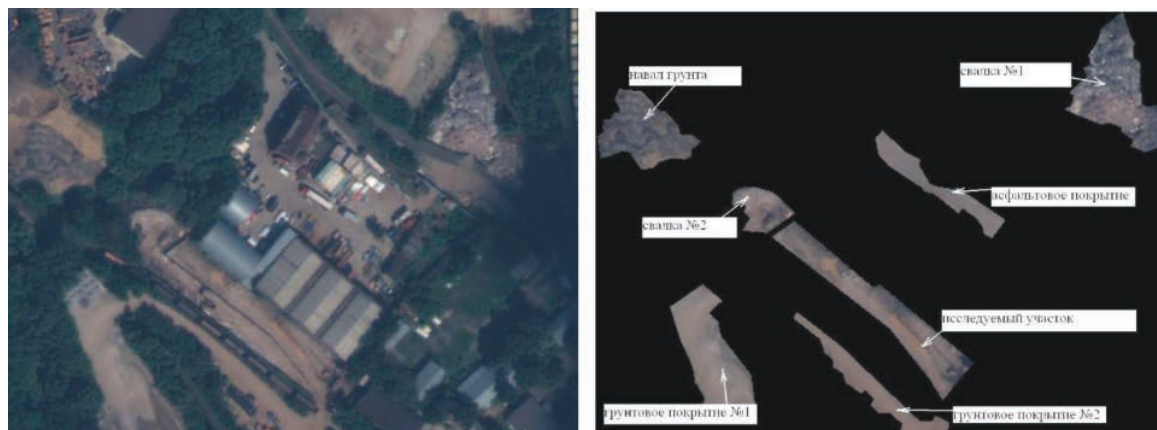
Фото 1. Общий план места происшествия на космическом снимке на дату 06.08.2015: слева – в цветовой синтезе RGB 1,2,3 – цвета, близкие к натуральным; справа – результат векторизации в программе SAGA GIS. Параметры снимка: файловый формат – TIFF; пространственное разрешение 0,5 м в пикселе
