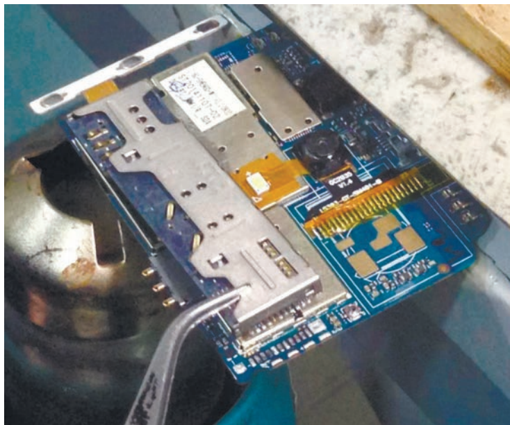
Фото 3. Подогрев платы феном со стороны впаянных выводов для снятия защитного экрана Photo 3. Heating the PCB with a blow dryer on the side with soldered pinouts to remove protective shielding
