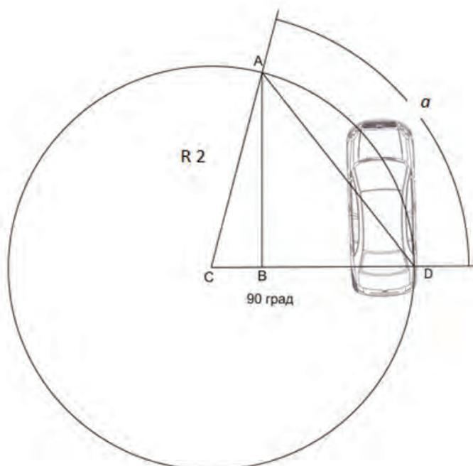
Рис. 2. Поперечное смещение заднего правого колеса автомобиля
