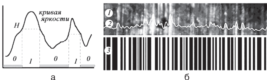
Рис. 1. Преобразование исходного изображения, представленного в градациях серого, в бинарный вид: а – фрагмент кривой яркости; б – исходное изображение следа (1) с кривой средней яркости по столбцам (2), исходное изображение в бинарном виде, полученное методом сечения кривой яркости (3)
