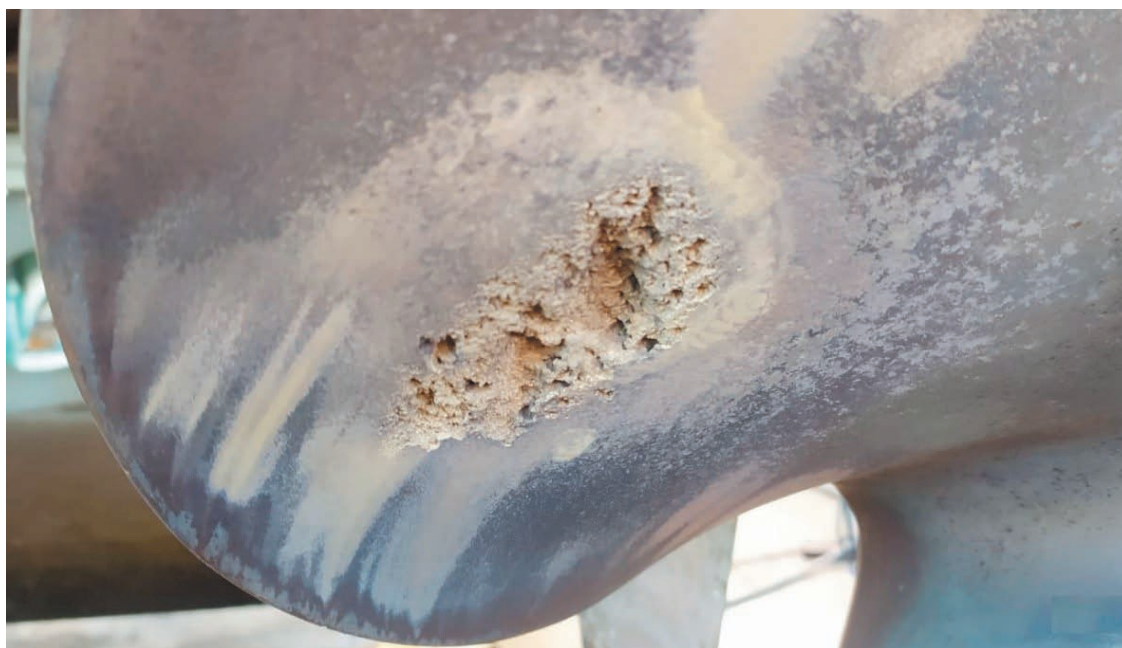
Рис. 2. Эрозионное разрушение поверхности лопасти гребного винта, вызванное кавитационным процессом Fig. 2. Erosive destruction of the propeller blade surface caused by the cavitation process
