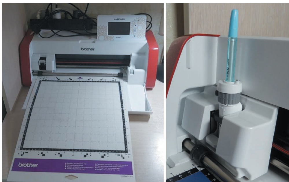
Рис. 9. Режущий плоттер Brother SDX900 10 : внешний вид с установленной гибкой основой для крепления материала (слева), каретка с пишущим прибором (справа)
