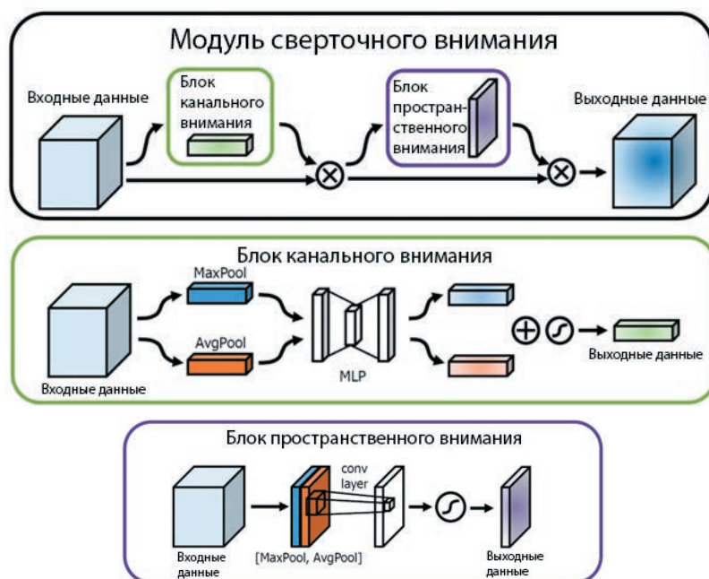
Рис. 1. Общее устройство модуля СВМ (верх), устройство блока канального внимания (центр), устройство блока пространственного внимания (низ) [12]
