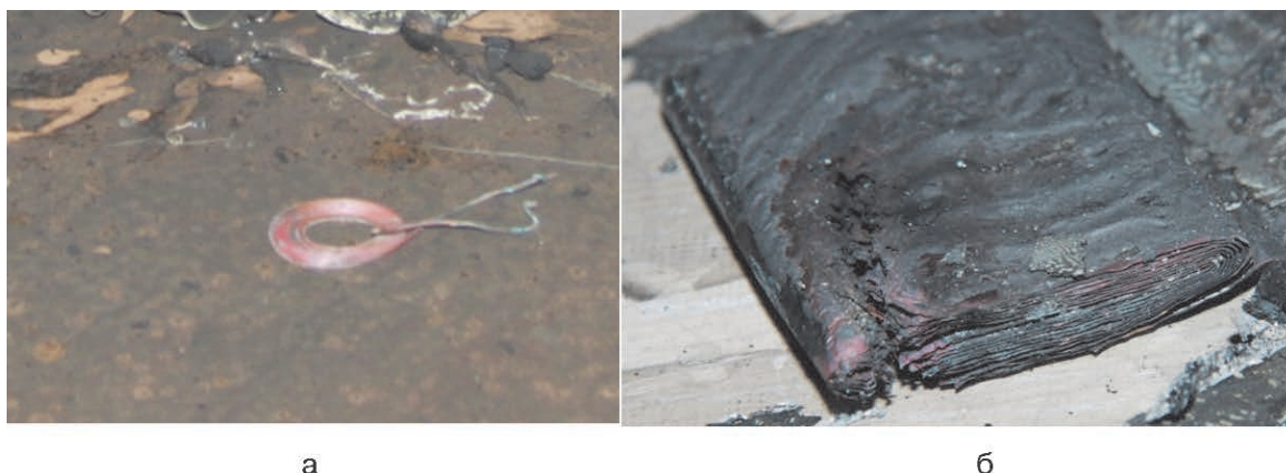
Рис. 10. Вид, предположительно, катушки индуктивности (а) внешнего аккумулятора (power bank) и поврежденного при пожаре литий-ионного аккумулятора (б) Fig. 10. Presumably a view of an inductor coil (a) of an external battery (power bank) and a lithium-ion battery damaged in a fire (b)
