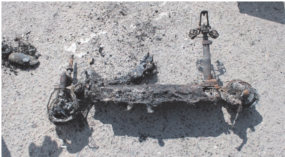
Рис. 5. Остатки поврежденного пожаром электросамоката, обнаруженного на территории павильона, где возник пожар Fig. 5. Remains of an electric scooter damaged by fire found on the territory of the pavilion where the fire broke out
