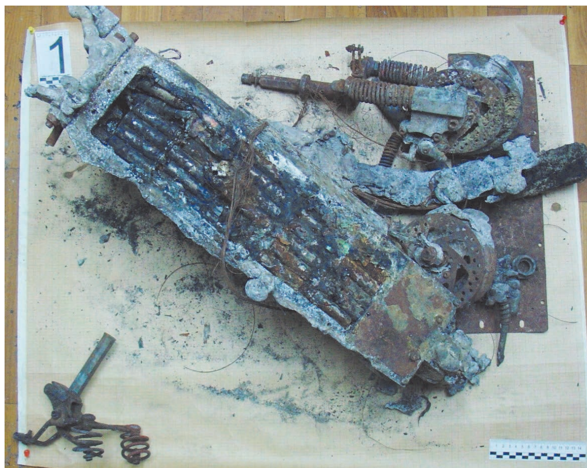
Рис. 6. Состояние поврежденной пожаром аккумуляторной батареи электросамоката. В центральной части отсека АКБ несколько цилиндрических элементов отсутствуют Fig. 6. The condition of an electric scooter's battery damaged by fire. There are several cylindrical elements missing in the central part of the battery compartment
