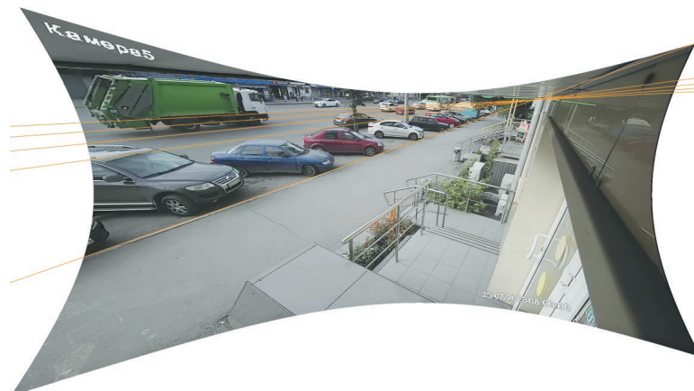
Рис. 18. Коррекция оптических искажений и прорисовка полос, разграничивающих движение транспортных потоков одного направления, по референсному кадру
