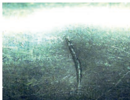
Фото 8. След типа LF (Light Frown) – след, изогнутый в сторону дна гильзы (на 26 латунных гильзах)
