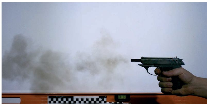
Фото 20. Кадр высокоскоростной видеосъемки, на котором иллюстрируется распространение газопороховой струи при выстреле из пистолета без глушителя (пуля покинула канал ствола, затвор движется назад)
