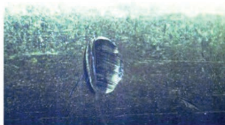
Фото 10. След типа SD (Small Dents) – след в виде зазубрины с выраженными крупными особенностями микрорельефа (на 30 стальных гильзах)
