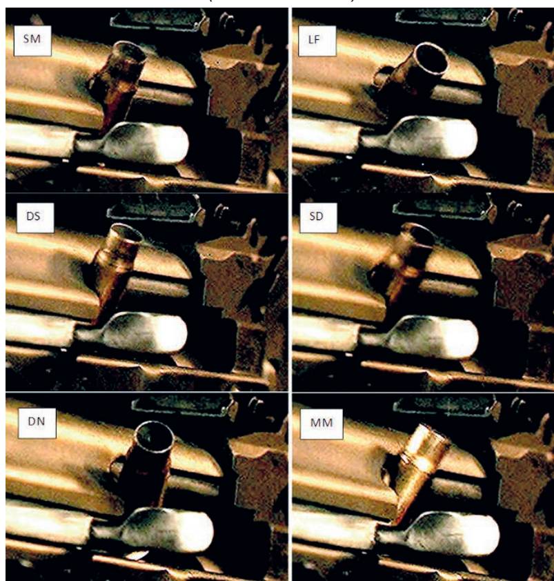
Фото 12. Кадры видеозаписи, демонстрирующие локализацию места и угла взаимодействия гильзы с крышкой ствольной коробки для определенных типов следов
