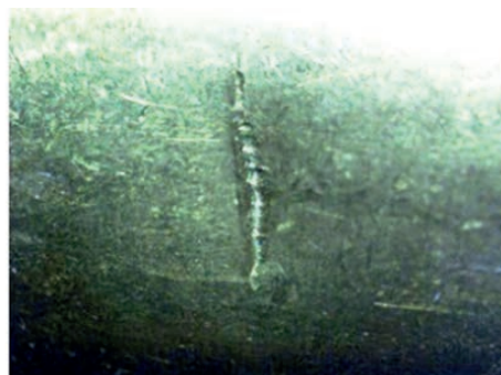
Фото 7. След типа SM (Small Mark) – одиночный линейный след с выраженными крупными особенностями микрорельефа (на 52 латунных гильзах)
