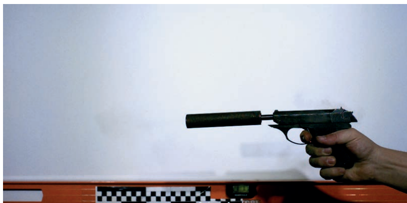
Фото 19. Кадр высокоскоростной видеосъемки, на котором иллюстрируется распространение газо-пороховой струи при выстреле из пистолета с использованием глушителя (пуля покинула канал ствола и глушитель, затвор движется назад)
