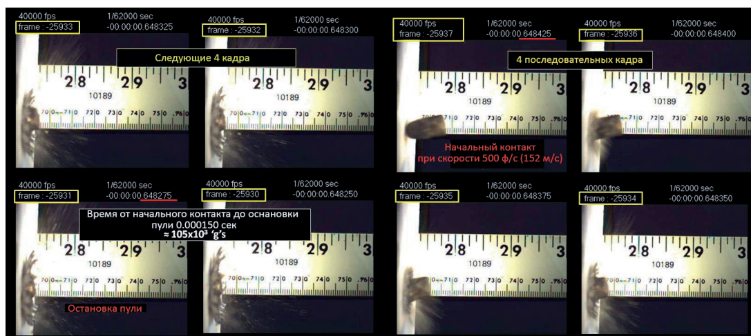
Фото 2. Кадры разрушения оболочечной пули калибра .38 (9,0 мм). Скорость удара 152 м/с, время от начала контакта до полной остановки 0,000150 сек, перегрузка 105 \times 10^3 \text{ g}
