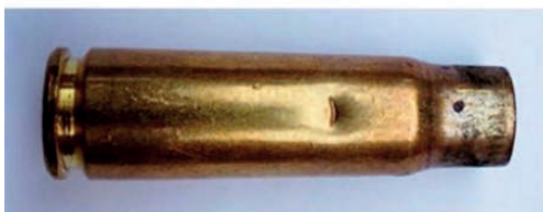
Фото 8. След типа LF (Light Frown) – след, изогнутый в сторону дна гильзы (на 26 латунных гильзах)
