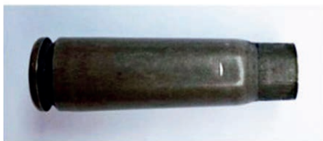
Фото 10. След типа SD (Small Dents) – след в виде зазубрины с выраженными крупными особенностями микрорельефа (на 30 стальных гильзах)
