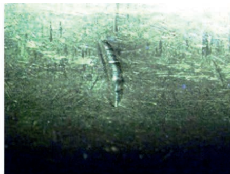
Фото 11. След типа DN (Deep Notches) – глубокая вмятина с выраженными особенностями микрорельефа (на 54 латунных гильзах)
