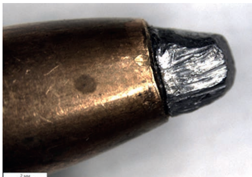
Фото 18. Следы контакта с костной тканью на вершинке экспериментальной пули
