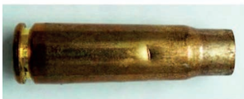
Фото 7. След типа SM (Small Mark) – одиночный линейный след с выраженными крупными особенностями микрорельефа (на 52 латунных гильзах)
