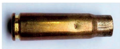
Фото 11. След типа DN (Deep Notches) – глубокая вмятина с выраженными особенностями микрорельефа (на 54 латунных гильзах)
