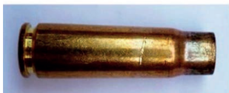
Фото 9. След типа DS (Deep Smile) – след, изогнутый в сторону дульца гильзы (на 13 латунных гильзах)
