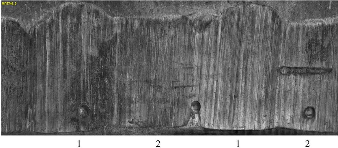
**Фото 2.** Следы сверловки «Ланкастер» на ведущей части выстреленной пули (охотничий карабин АК–366 Ланкастер кал. .366 ТКМ, пуля FMJ): 1 – след поля нарезки; 2 – след нарезки
