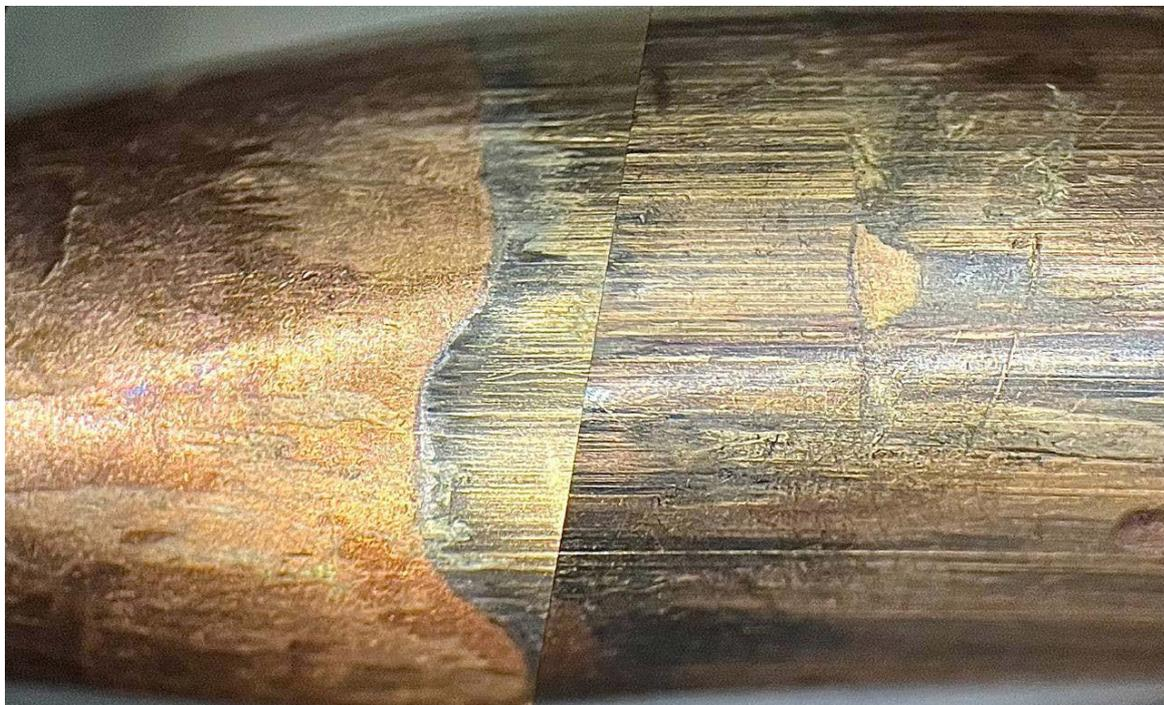
**Фото. 4.** Совмещение следов полей и нарезав канала ствола на оболочечных пулях FMJ, выстреленных в охотничьем карабине АК–366 Ланкастер кал. .366 ТКМ
