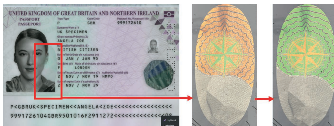
Рис. 6. Защитный элемент DID® при повороте на 90 градусов на паспорте Великобритании Fig. 6. DID® security feature when rotated 90 degrees, displayed on the UK passport
