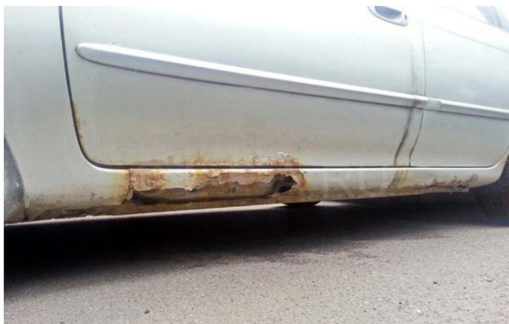
**Фото 1, 2.** Коррозия (в том числе сквозная) кузовных составных частей автомобилей
