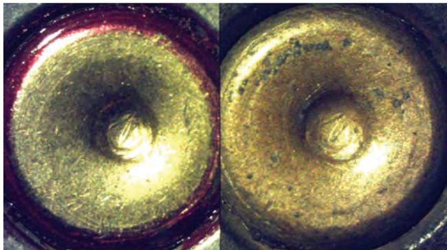
Рис. 5. Сопоставление следов оружия на донной части выстреленных гильз: слева гильза без следов термического воздействия, справа – гильза, обожженная при температуре 750 °С и времени обжига 20 минут.
