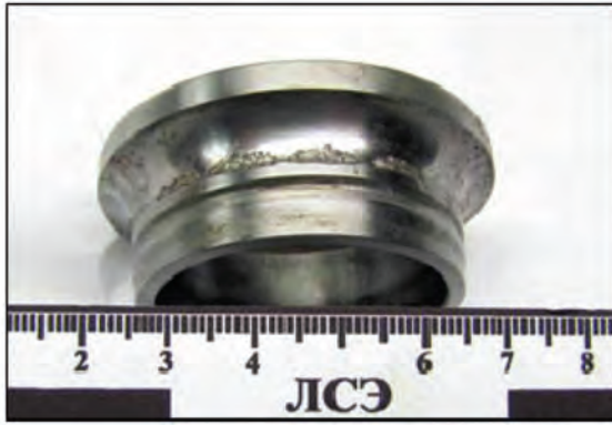
Рис. 1а. Локализация повреждений на поверхности внутреннего кольца подшипника
