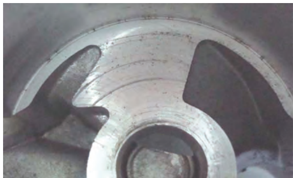
Рис. 4б. Глубокие царапины на опорной части корпуса насоса. х1,5
