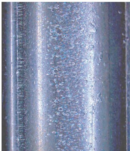
Рис. 4а. Вид неровностей на поверхности на рабочей поверхности внутренней шестерни. х8
