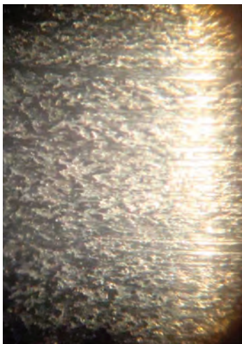
Рис. 2а. Вид неровностей на поверхности ротора. х5
