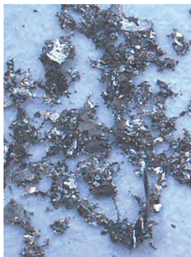
Рис. 2б. Вид металлических частиц, обнаруженных внутри камеры. х20
