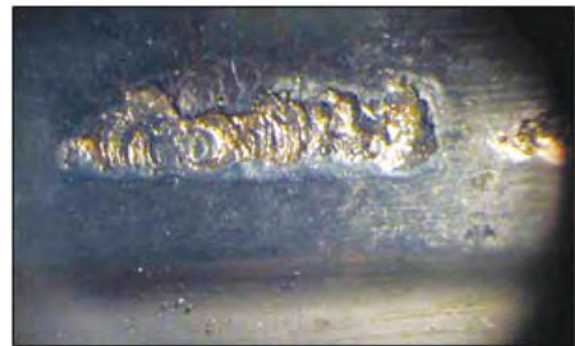
Рис. 1б. Усталостные бороздки в дне следа контакта тел качения. X7
