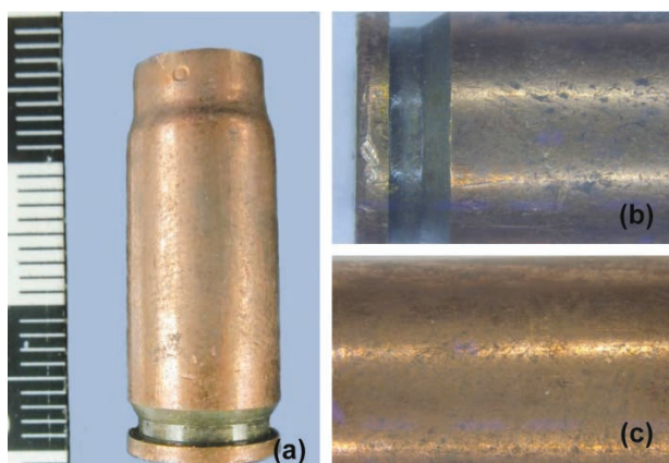
Рис. 3. (а) – гильза патрона 7,62 x 25 мм, стрелянная из пистолета ТТ, со следом, выявленным окислительно-восстановительным методом; (b, c) – увеличенный фрагмент папиллярного узора на гильзе
