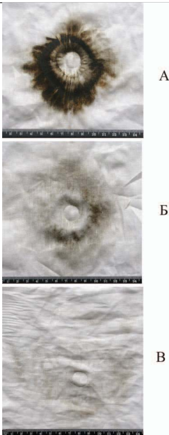
Фото 28. Общий вид следов выстрела на ткани, образованных выстрелами практическими патронами 18х45 производства ГУП ФНПЦ «НИИ прикладной химии» с дистанций: А – 0 см (упор), Б – 5 см, В – 20 см.
