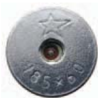
Фото 25. Маркировка на дне гильзы патрона 18,5х60Т.
