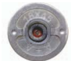
Фото 15. Донная часть гильзы патрона 18x45 производства ООО «А+А» (для контрастности изображения, поверхность обработана черным дактилоскопическим порошком).
