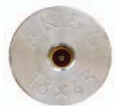
Фото 14. Маркировка гильзы патрона 18x45РШ производства ООО «АКБС».
