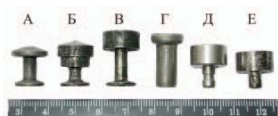
Фото 9. Общий вид стальных сердечников пуль травматических патронов комплексу «Оса»: А – первоначального варианта пули патрона 18х45Т производства ГУП ФНПЦ «НИИ прикладной химии», Б – модернизированного варианта пули патрона 18х45Т производства ГУП ФНПЦ «НИИ прикладной химии», В – пули патрона 18х45Т производства ООО «Новые оружейные технологии», Г – пули патрона 18х45Т производства ООО «А+А», Д – пули патрона 18,5х55 производства ООО «А+А», Е – один из вариантов пули патрона 18,5х60Т.
