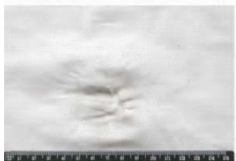
Фото 29. Общий вид следов выстрела на ткани, образованных выстрелами патронами 18х45РШ с дистанций: А – 0см (упор), Б – 5 см, В – 20 см.
