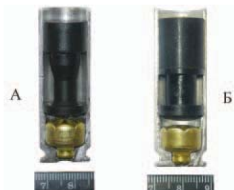
Фото 19. Продольный механический разрез гильзы патрона 18,5х55Т (А) и патрона 18,5х55ТД (Б) производства ООО «Новые оружейные технологии».
