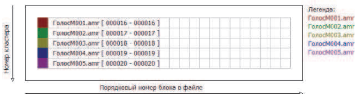
Рис. 5. Размещение шести нефрагментированных файлов, следующих друг за другом, каждый из которых занимает один блок кластеров
