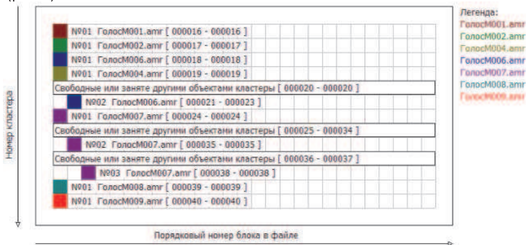
Рис. 6. Размещение семи файлов, два из которых фрагментированы
