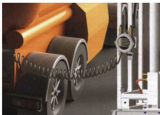
Рис. 3. Заземление автоцистерны конструкции ОАО "ПРОМПРИБОР"[8].
