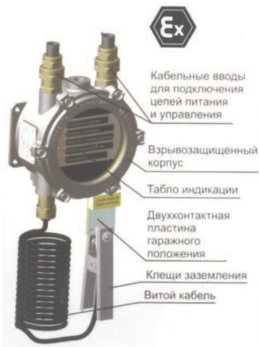
Рис. 4. Блок заземления автоцистерн (БЗА) конструкции ОАО "ПРОМПРИБОР" [8].
