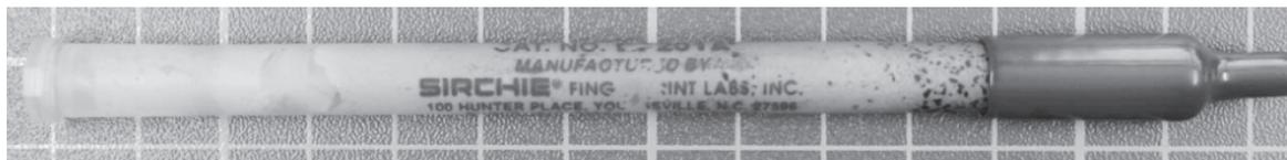
Рис. 6. Йодная трубка для работы на осмотрах мест происшествий производства компании «SIRCHIE» (США)
