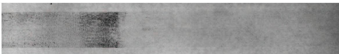
Рис. 10. След бумагозахватывающего валика, выявленный с помощью йодной трубки непосредственно после прохождения через БПС
