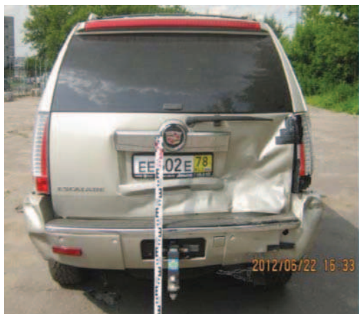
Фото 3,4. Образование парных следов при попутном столкновении.
