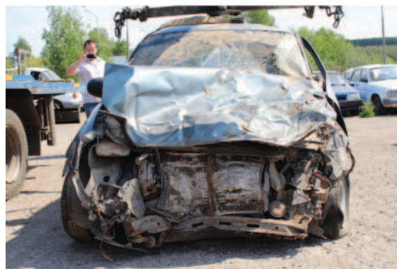
Фото 5. Повреждения автомобиля, полученные при блокирующем столкновении.
