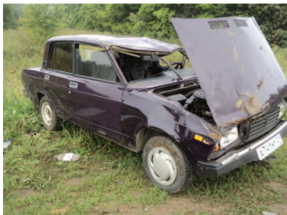
Фото 7. Повреждения панели крыши автомобиля, полученные при опрокидывании.
