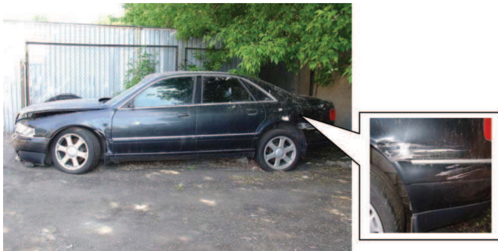
Фото 6. Повреждения, полученные автомобилем при касательном столкновении.
